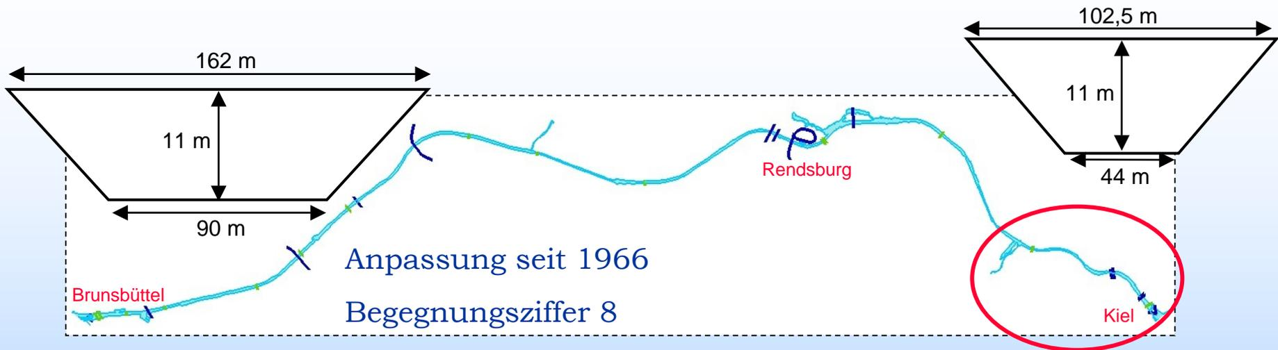
Kanalquerschnitt von 1914
